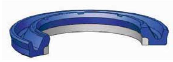
K29是單向緩沖密封，由一個特殊設計以疏散後部壓力的橡膠密封件和一個熱塑性塑料承托環組成。
