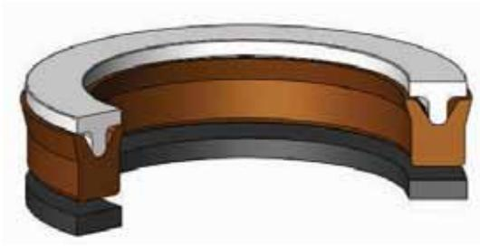
K151是單向雪弗龍密封件，由一個聚氨酯頂環，一個丁睛橡膠與夾織物製成的密封件和一個聚四氟乙烯承托環組成。
